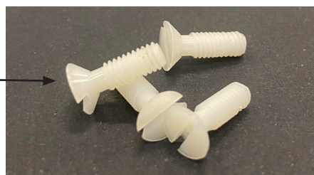
Fig.8a. Tornillos de teflón usados en apertura lateral de campanas
