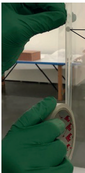
Fig.8. Cinta transparente de sellado para lograr mayor estanqueidad en la campana cuando está cerrada con tornillos
