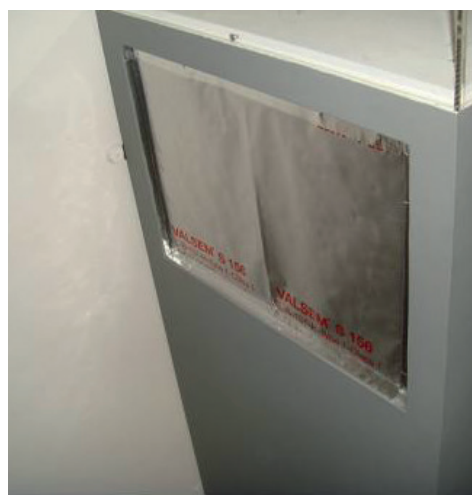
Fig. 5. Habitación sellado con Valsem® para crear la estanqueidad entre la campana y la parte superior de la base, donde se deposita el material regulador de la humedad.
