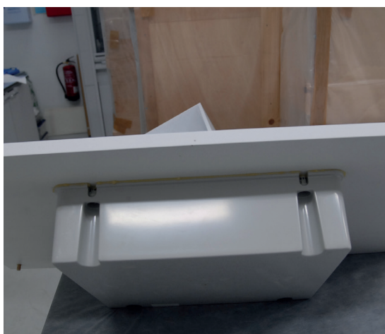
Fig. 2. Cajón de polietileno para colocación de material regulador de humedad.
